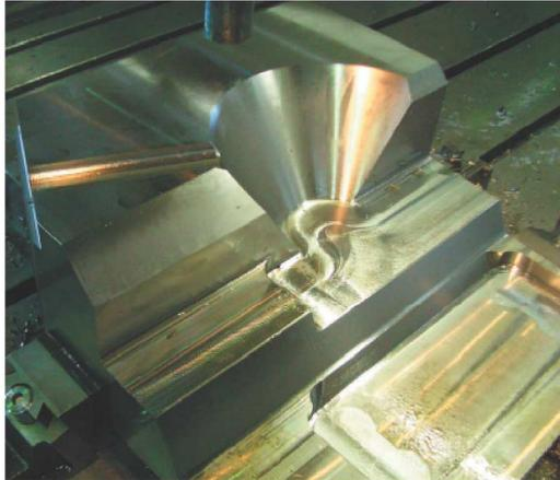
チャンバー内面の3次元削り出し
